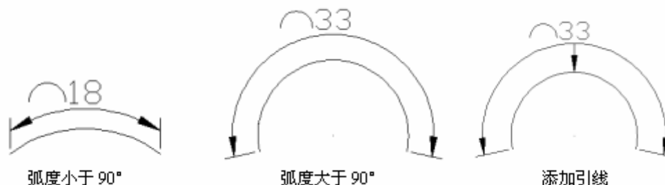
图 5-7 弧长尺寸标注
